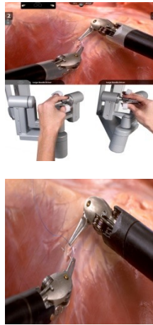
De sa console, le chirurgien commande 3 instruments et la caméra insérés dans le corps du patient
